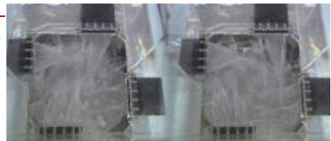
このフリップフロップ流れは、水などの流体を菱形の柱を網目状に配列した四角の管に流すと、管内に生じる渦により、管体から噴出する液体が、左右に規則正しくスイッチングする現象のことである。梅田教授によると、フリップ・フロップ流れを発生させるには、菱形角柱の分管路をある条件で配列することが必要であるが、それだけで全く稼動部を必要としない状態で流体が左右に振れることが特徴である。
